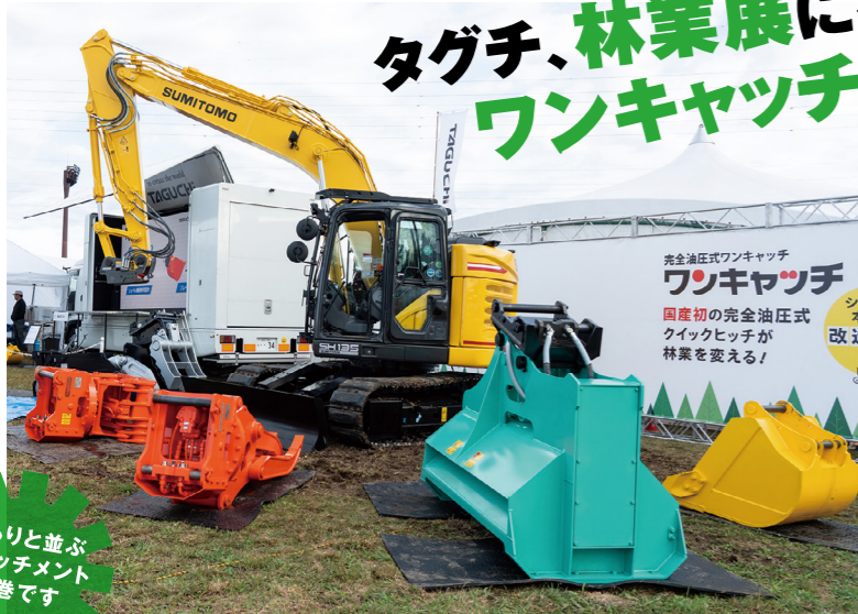
12tonショベル用完全油圧式ワンキャッチの着脱デモを実施。対応アタッチメントも増えたので見応えあり!
