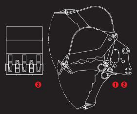
●油圧シリンダで開閉する首振り型(チルト式)
